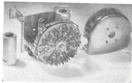
Il sintonizzatore a disco della GRUNDIG, senza lo schermo. Guardando il lato bobine del disco, le induttanze RF e dell'oscillatore di ciascun canale risultano disposte orizzontalmente sul lato destro. Gli altri componenti sono montati sotto i tubi.
